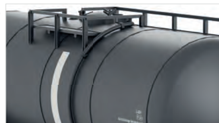
Extra angesetzte Leitung für Chemiekessel
