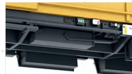
Langträger und Unterboden aufwendig umgesetzt
