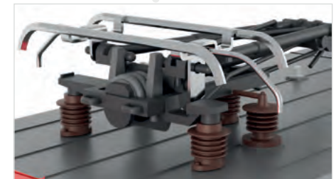
Stromabnehmer mit innovativer Befestigung
