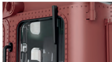
Scheibenwischer in alter Bauform ausgeführt
