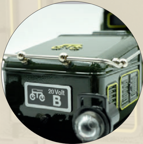
Übernahme des alten Originalschildes mit dem Hinweis auf die damals benötigte Mindest-Trafo-Leistung
