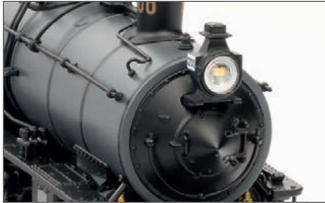
Neben dem Zweilicht-Spitzensignal ist das Notlicht an der Rauchkammer-tür separat digital schaltbar.
