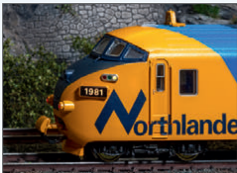
Die Nummerntafeln sind digital separat schaltbar
