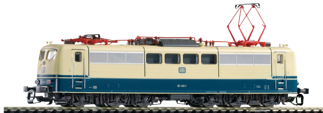
47202 E-Lok BR 151 DB Ep. IV mit Scheren-Stromabnehmer
