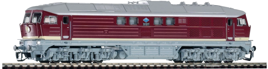
47326 Diesellokomotive BR 131 DR Ep. IV mit neuer Dachausüstung mit geänderten Lüftern
